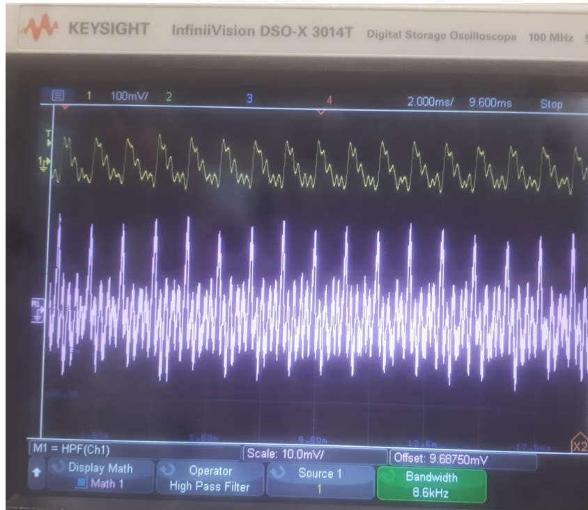
FIGURE 1.1 – Capture d'écran d'oscilloscope. Le signal temporel du son émis par la corde frottée du violon est capté par un micro et correspond à la trace du haut en jaune. La trace du bas en blanc est ce même signal après application d'un filtre passe-haut par l'oscilloscope avec une fréquence de coupure de 8,6 kHz. Réalisation C. Lafargue et S. L'Horset.
